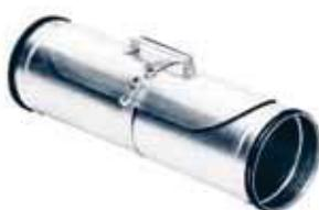
**KCRU:** Manguito macho con juntas con tapa de inspección incorporada con abertura/cierre "Fácil" con brida, para una conexión entre 2 elementos hembra (ej: conductos o accesorios hembra). El KCRU respeta la norma NF EN 12097. Clase de estanqueidad C. disponible de diámetro 100 a 400 mm.
