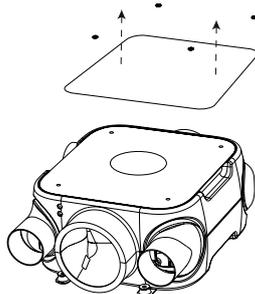
3 Desatornillar tuercas y levantar el soporte metálico del motor
